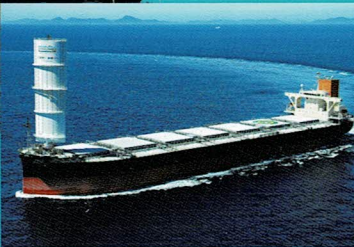
ウインドチャレンジャー (硬翼帆式風力推進装置) 搭載の貨物船「松風丸」(画像: 商船三井)
